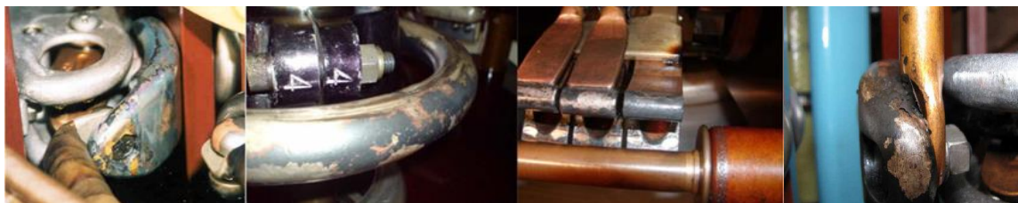
Slika 1: Korozija na srebru unutar suda TRP [16].
